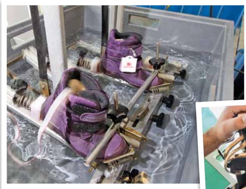
Auch in den Distributionszentren werden Schuhe geprüft. Hier muss ein Elefantenschuh zeigen, dass er selbst bei extremer Belastung kein Wasser durchlässt.
